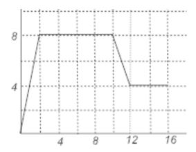
SOLUZIONE. La distanza percorsa può semplicemente essere calcolata, determinando l'area sottesa dalla poligonale che descrive il moto del corpo. In questo caso, ad esempio, l'area (colorata in giallo) può essere calcolata suddividendola in due trapezi e un rettangolo:
